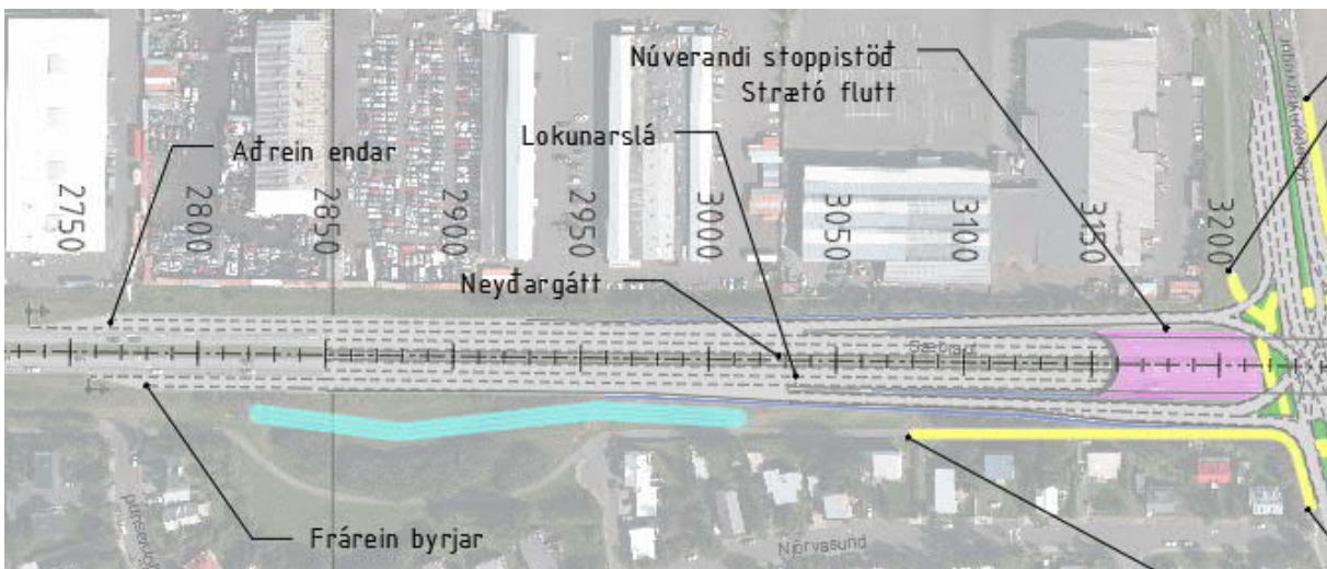
Mynd 5-4 Upphaf framkvæmdasvæðis og stokksmunninn í norðri. Bláar línur sýna fyrirhugaðar hljóðvarnir en þær verða skoðaðar nánar á seinni stigum. Gular línur sýna gönguleiðir.
